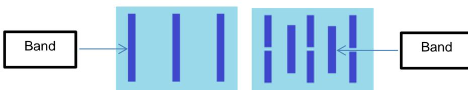
**AGC empfiehlt die Verwendung von mindestens zehn Streifen à 10 x 100 mm pro 10 kg lackiertem Glas sowie die Anbringung mehrerer kürzerer Stücke statt eines langen Einzelstreifens (wie oben rechts skizziert).**
